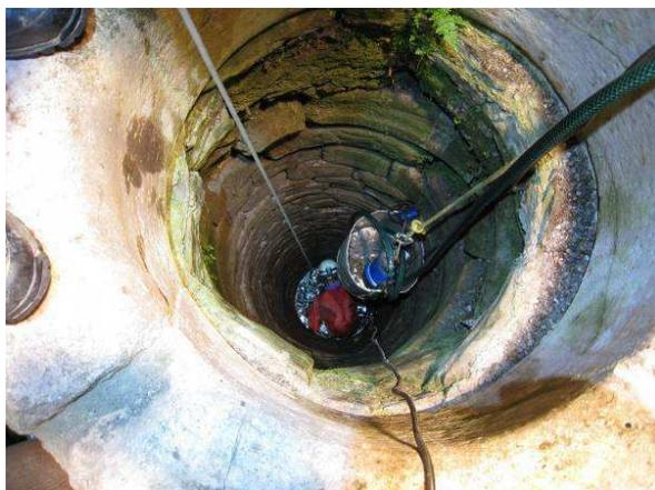
Bild 4 – Kaskaden-Pumpen
