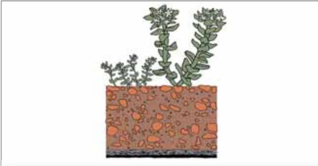
Prinzip der Extensivbegrünung: Auf der Dachabdichtung genügen ein starkes Vlies und einige Zentimeter Substrat, um 50% des Niederschlags zurückzuhalten.
