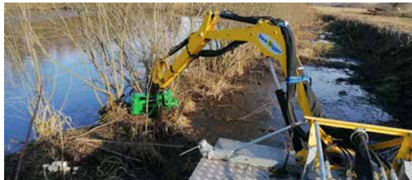
Das Amphibien-fahrzeug, Marke Truxor entfernt Gehölzreihen in einem Torfstichteichen. .
