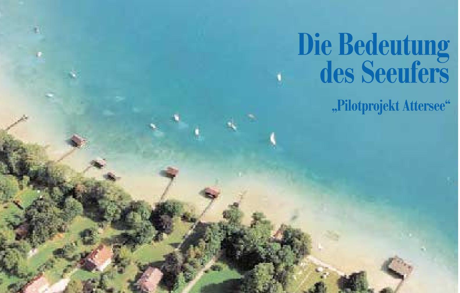
Am stärksten werden die Unterwasserpflanzen durch die am Boden schleifenden Bojenketten geschädigt. Solche Stellen sind aus der Luft als helle Flecken gut erkennbar.
