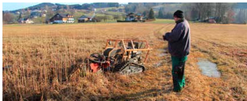
Andreas Mayer mit seinem Iru Deltrak beim Ausfräsen von Wurzelstöcken.
