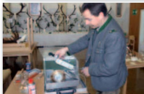
*Mit diesem Schleifgerät kann durch Zahnschliff das genaue Alter von Rotwild ermittelt werden*
