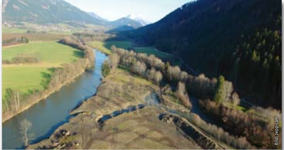
Gestaltung einer abwechslungsreichen Uferlinie mit kleinen Buchten und Initiierung von Schotterbänken entlang des Ennsufers: Setzen von Holzpiloten, Verankerung von Baumstämmen und Aufschüttung von Trockenstandorten
