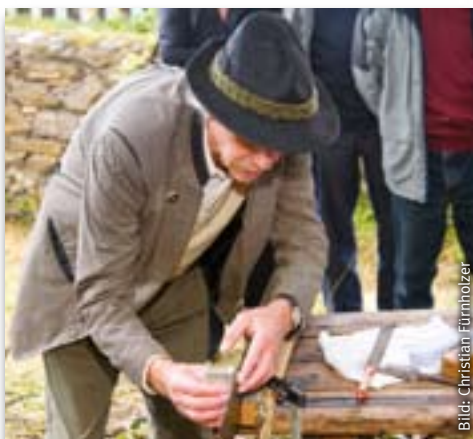
Der richtige Schliff: Wie schrenkt und feilt man eine Zugsäge?
