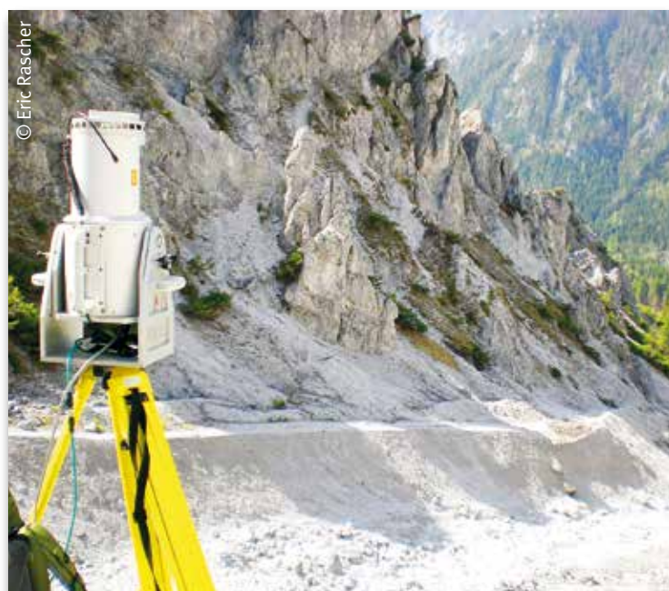
Im Gsengraben werden die seitlichen Sedimenthalden mehrfach im Jahr mittels Terrestrischem Laserscanning (TLS) vermessen.
