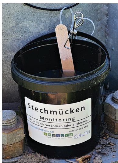
Abb. 3: Links: Ovitrap (OT) mit Fassungsvermögen ca. 1 l. Rechts: Gravid Aedes Trap (GAT) ca. 3 l. (Fotos: Klaus Zimmermann).
