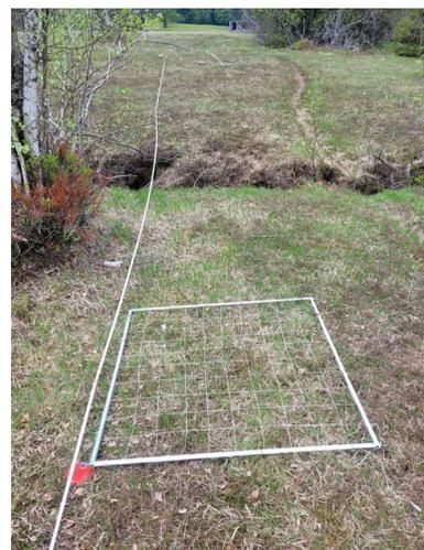
Abb. 3: Frequenzrahmen, angelegt am Messpunkt entlang des Transekts C.
