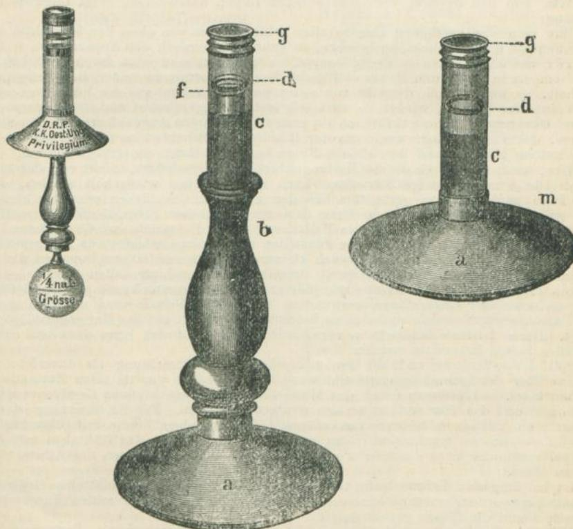
Beim Gebrauch wird der Fangschirm **a**, der dem Apparate zugleich als Fuss dient, auf die Glasmöhre **c** gesteckt, an der Verbindungsstelle, dem kleinen Blech-Ringe **m** mit zwei
