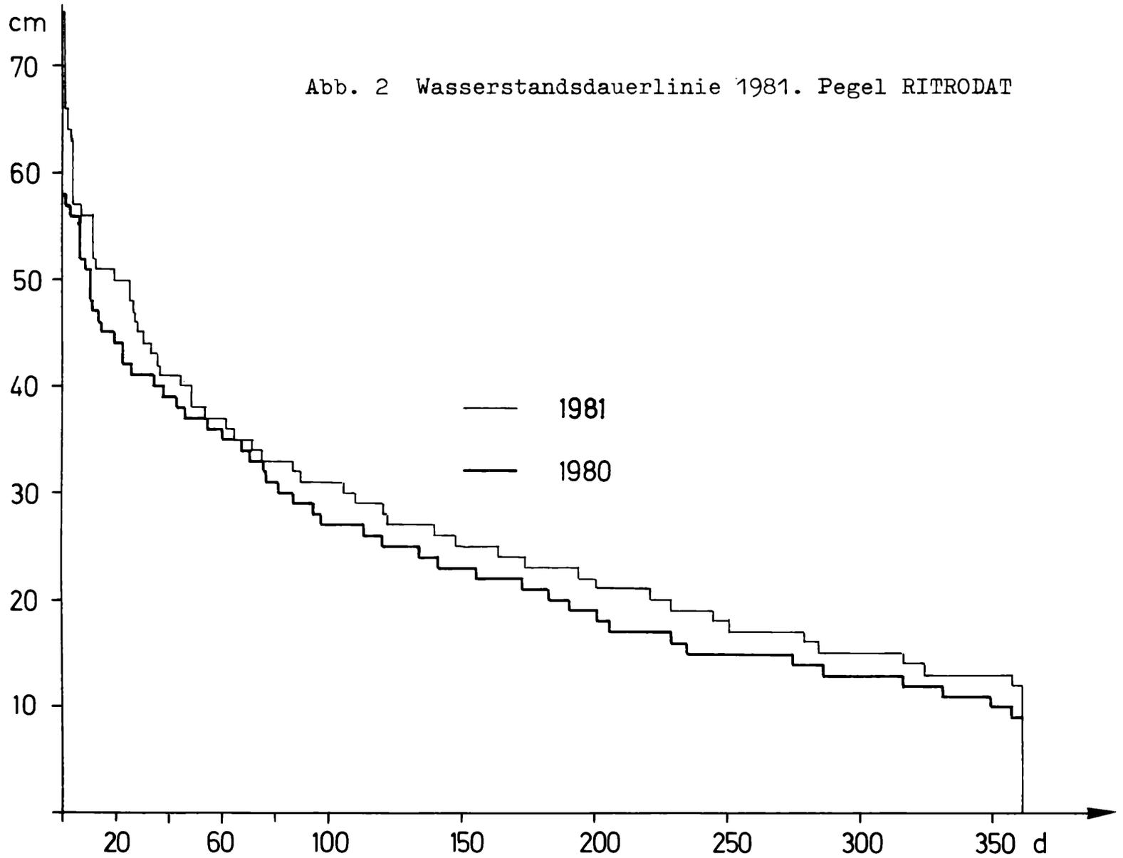
Abb. 2 Wasserstandsdauerlinie 1981. Pegel RITRODAT
