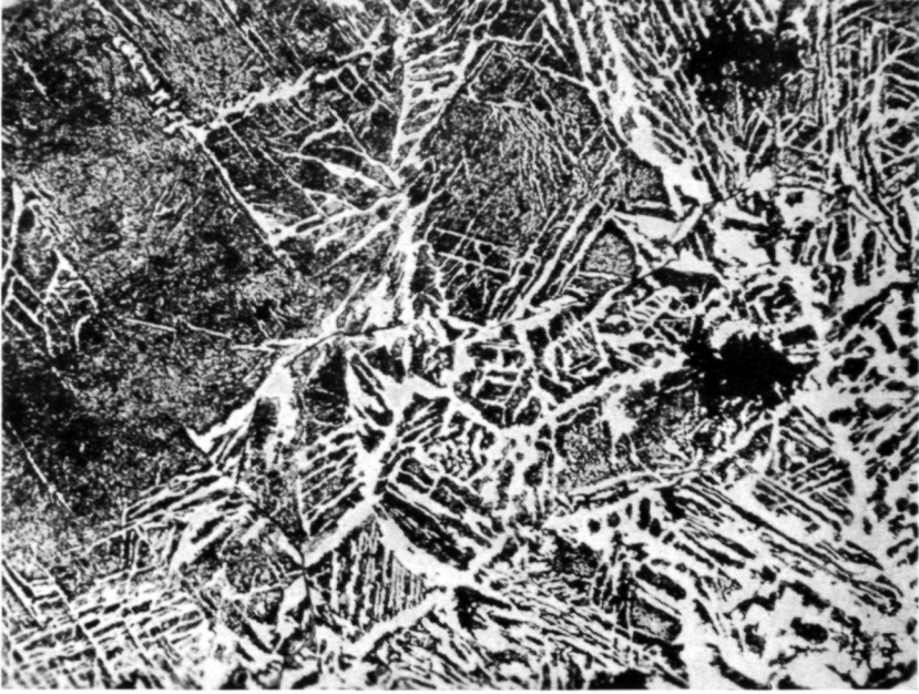
Abb. 4: Eisenstück. V = 75 ; HNO_3 — Ätzung
