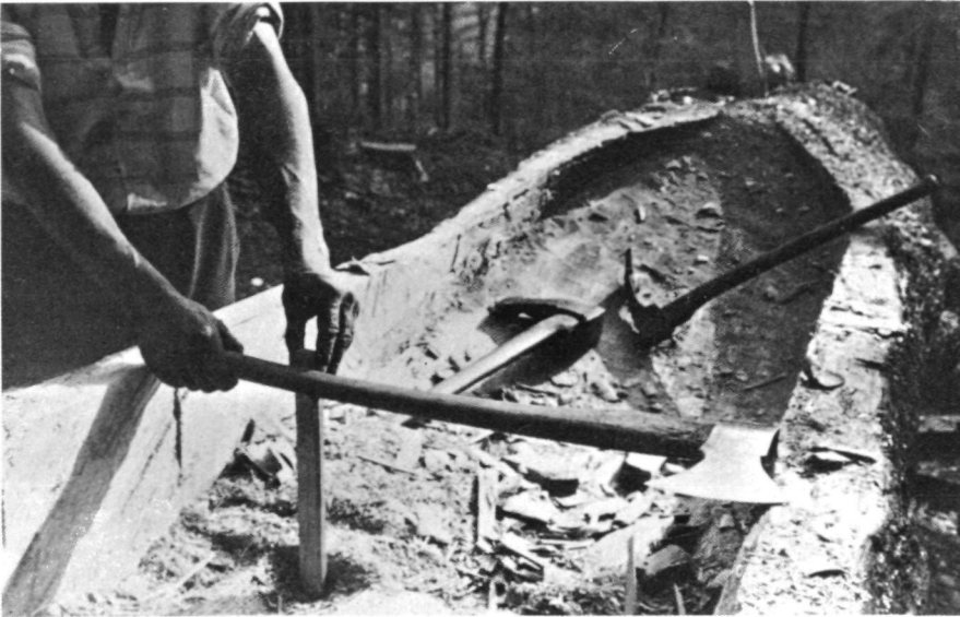
Abb. 8 Messen mit dem "Tiefenmaß".
