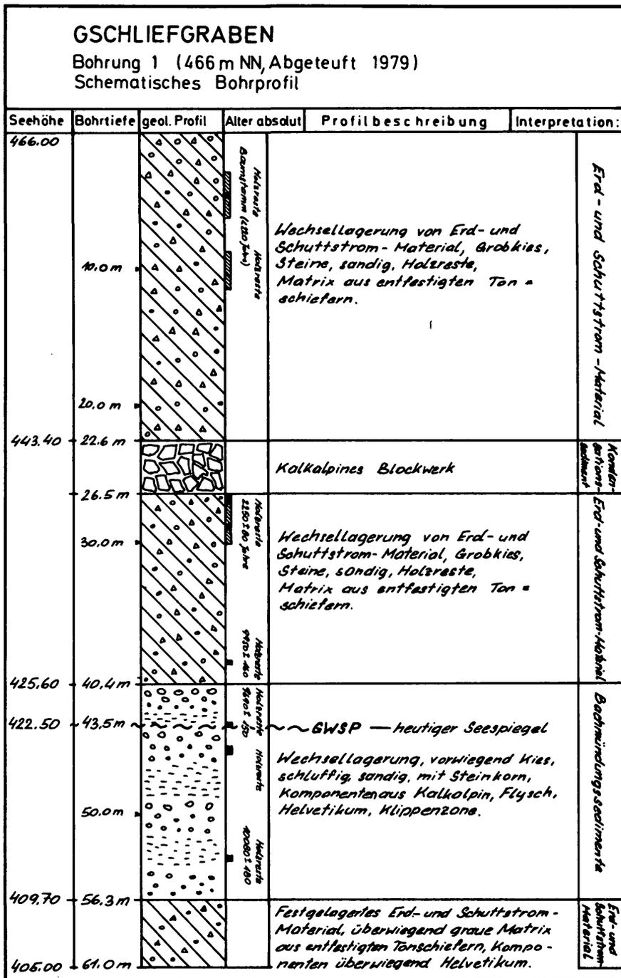
Abb. 2: Bohrung 1; Bohrprofil geologisch beschrieben und gedeutet
