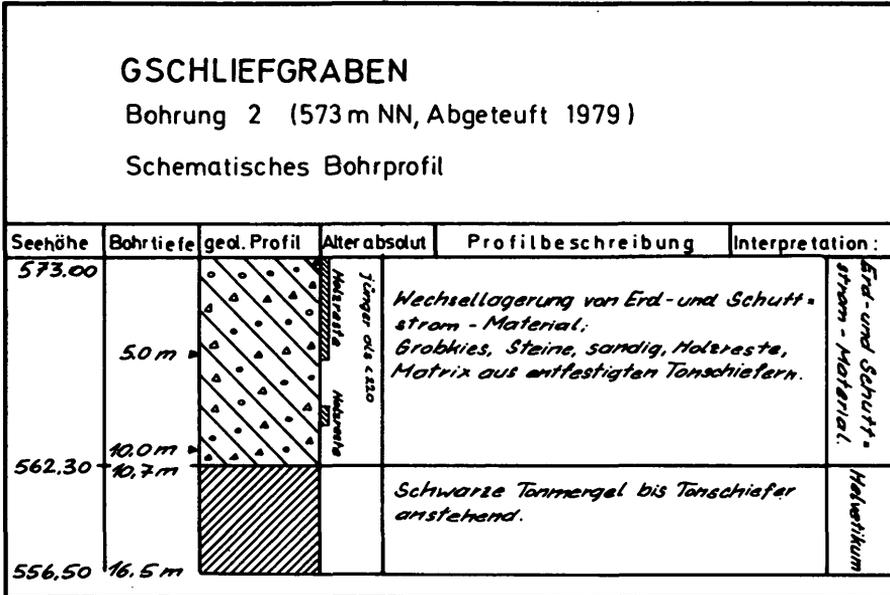
Abb. 3: Bohrung 2; Bohrprofil geologisch beschrieben und gedeutet
