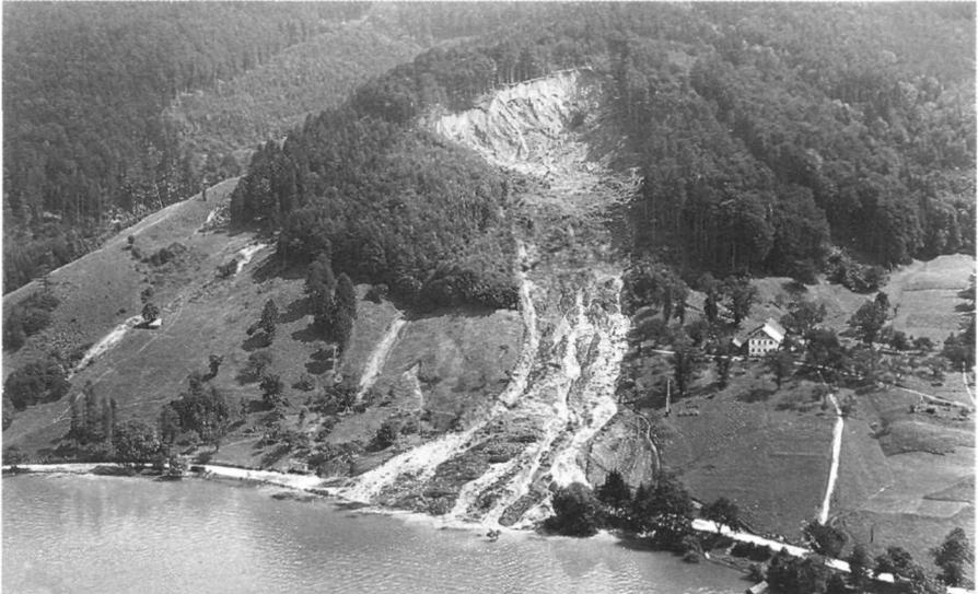
Abb. 140: Jägermaiersrutschung 1959, Kammerl bei Schörfling am Attersee. Ausbruchsnische im Flysch. Rutschmasse mit Moränenmaterial vermengt. Das angestaute Wasser hatte mehrere Murengänge ausgelöst. Foto: WESTMÜLLER
