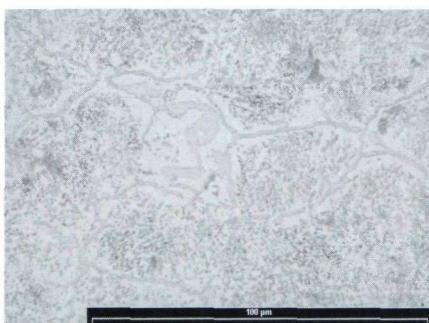
Im Schneidematerial ist Perlit und Zementit mit Ferrithöfen zu erkennen.
