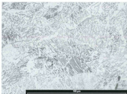
Perlitisches Gefüge im Rückenmaterial.
