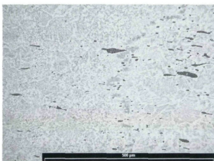
Eine vertikal verlaufende Schweißnaht verbindet das schlackenhaltige Kernmaterial mit dem Schneidematerial.
