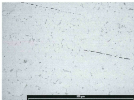
Ferritisch-perlitisches Gefüge im Klingenkern eingestreckte Schlacken.
