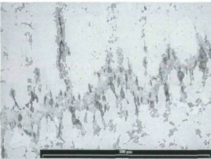
Eine aufgekohlte Schweißnaht mit Schlackeneinschlüssen verbindet das Rückenmaterial mit dem ferritisch-perlitischen Schneidematerial.
