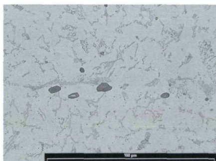
Aufgekohlte Schweißnaht der Damastmarke.
