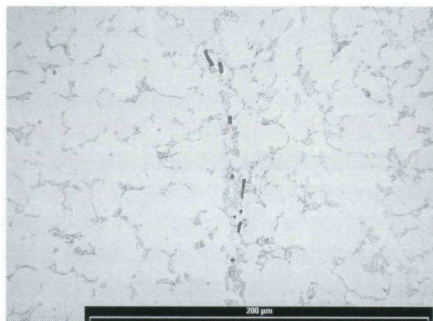
Ferrit mit Korngrenzenperlit, aufgekohlte Schweißnaht mit Schlackeneinschlüssen im Rückenmaterial.
