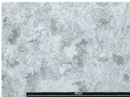
Perlit und körniger Zementit im Schneidenbereich.
