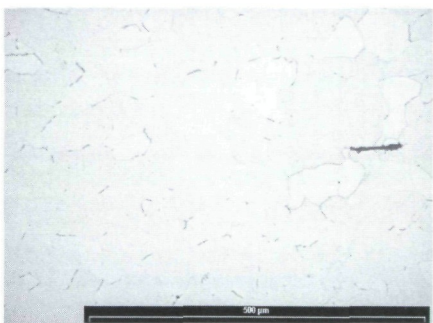
Probe-Spitze: Ferritisches Gefüge im Kern.
