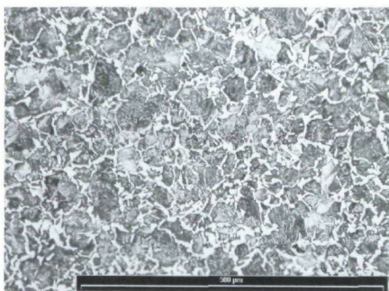
Probe-Spitze: Widmannstättengefüge in der Schneide.
