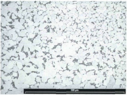
Ferritisch-perlitisches Gefüge einer Damastlage.
