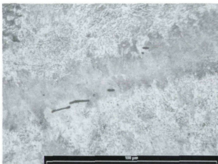
Schweißnaht im Kern, perlitisches Gefüge.
