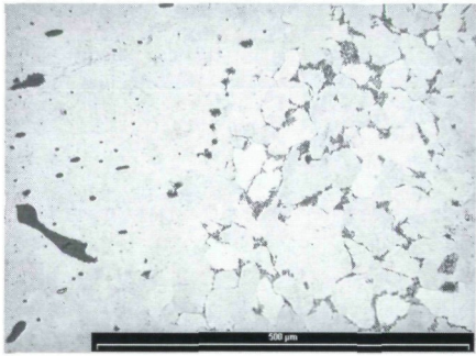
Links sind Schlackeneinschlüsse im Ferrit vorhanden, am Übergang zum ferritisch-perlitischen Gefüge kann keine Schweißnaht festgestellt werden.
