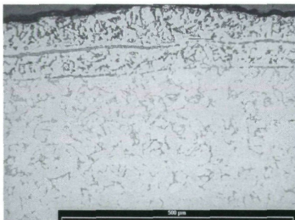
Aufgekohlte Schweißnähte im Kernmaterial, Ferritisches-perlitisches Gefüge im Klingenkern.
