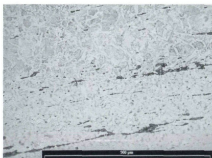
Ferritisch und perlitisch-ferritisches Gefüge im Klingenkern, eingestreckte Schlacken.
