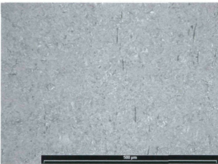
Härtegefüge an der Schneide.
