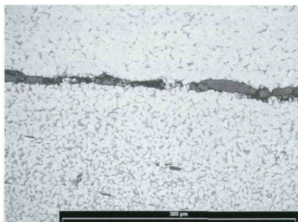
Ferritisch-perlitisches Gefüge im Klingenkern, eingestreckte Schlacken.
