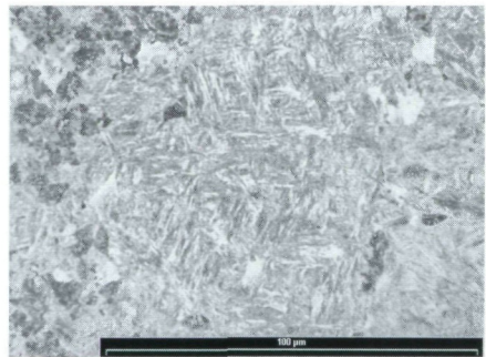
Martensit und Bainit an der Schneide.
