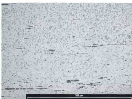
ferritisch-perlitisches Gefüge im Klingenkern eingestreckte Schlacken.
