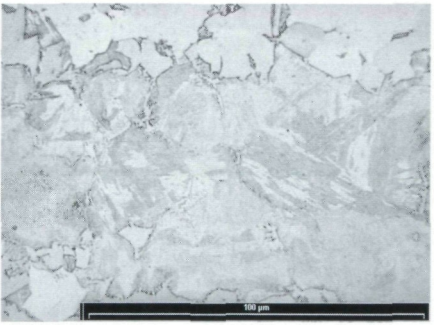
Härtegefüge in der Schneide, neben Martensit ist Bainit vorhanden.
