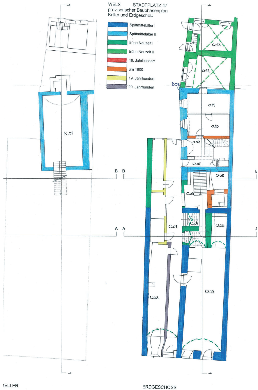
Abb. 15: Vorläufiger Bauphasenplan Keller und Erdgeschoß.
