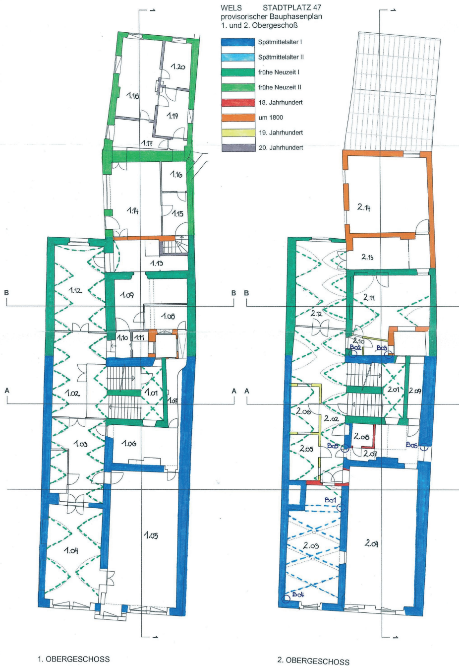
Abb. 16: Vorläufiger Bauphasenplan 1. und 2. Obergeschoß.
