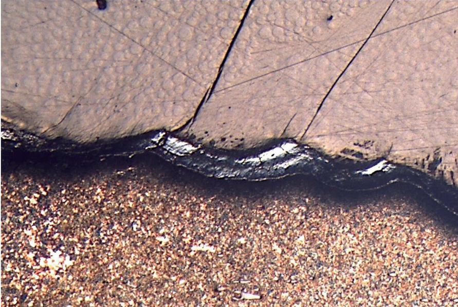
Bild 4 Schliffbild von der gehärteten Klingenschneide mit Perlit und Martensit, Nital-Ätzung
