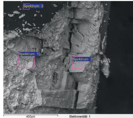
Abb. 8: Rückstreuелеktronenbild des kristallinen Oberflächenbereiches des hallstattzeitlichen Nadelfragmentes.
