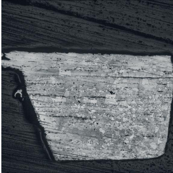
Abb. 8: Stahlprobe 2 – Ferrit und Schlackenzeilen über den gesamten Probenquerschnitt, Nital-Ätzung.
