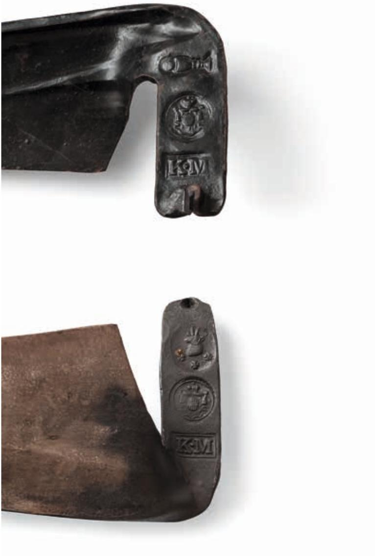
Abb. 24a, b: Gemärkte Sensenhammen mit den Zeichen „Kelch“ (a) und „Garnskopf“ (b) sowie Beischlägen des Erblandwappens und „K-M“. Micheldorf, OÖ. Sensenschmiedemuseum
