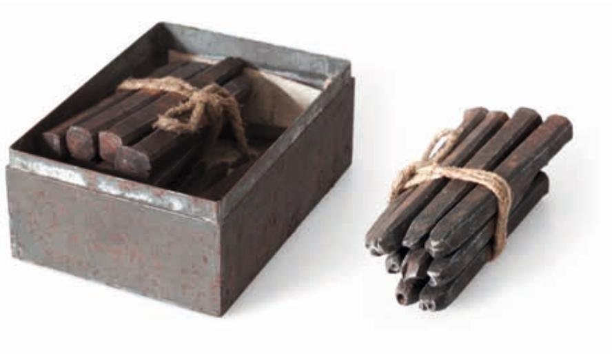
Abb. 31a, b: Schlagstempel mit Ziffern (b), in Blechschachtel (a).
