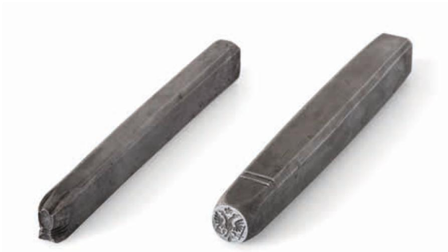
Abb. 28a, b: Schlagstempel mit dem Zeichen „Kelch“ (a) und Doppeladler (b).
