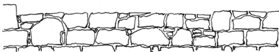
Abb. 33: Mauertechnik, Scharfolgen (nach Seifert 1938).
