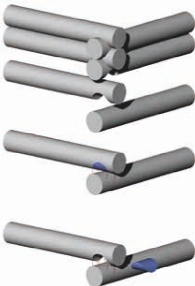
Abb. 58: Axonometrie Rundholzecke (Zeichnung: Idam).
