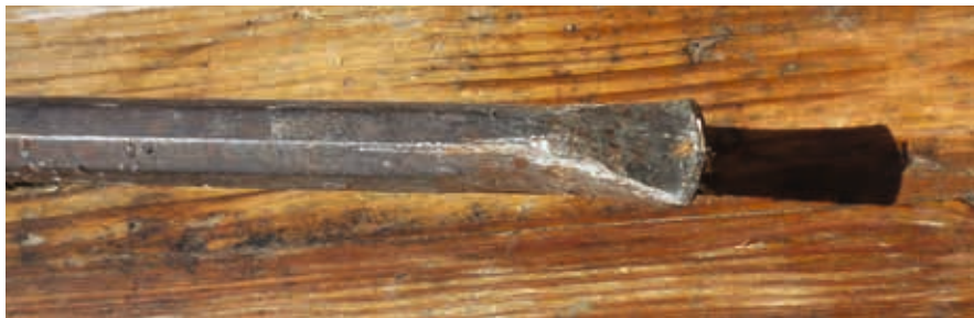
Abb. 9: Bohrmeißel, einschneidig (Foto: Kain 2014).
