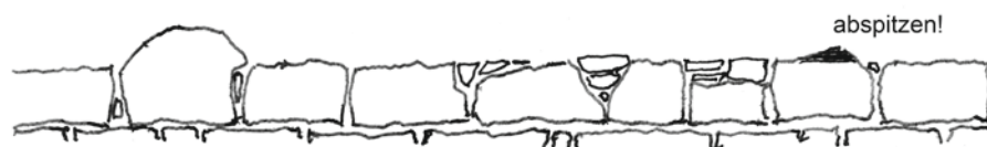
Abb. 31: Mauertechnik, Scharfolgen (nach Seifert 1938).
