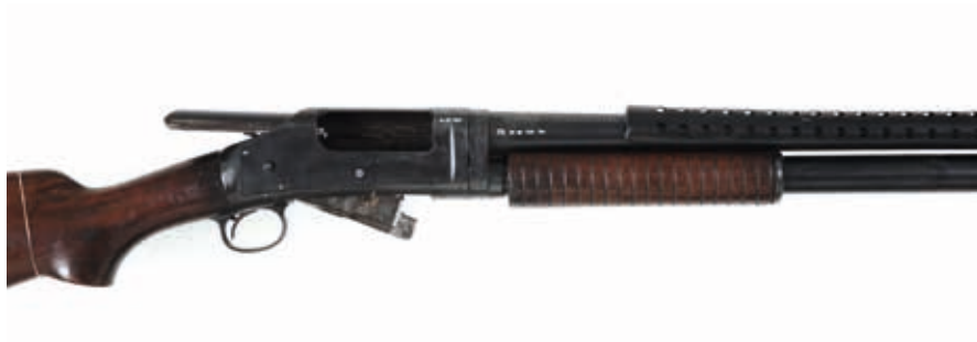
Abb. 3: Vorderschaftsrepetierflinte Modell 1912, USA, Detailansicht
