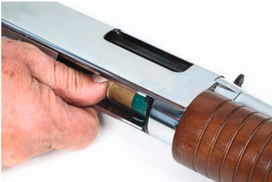
Abb. 6: Das Nachladen der Patronen in das Magazinrohr
