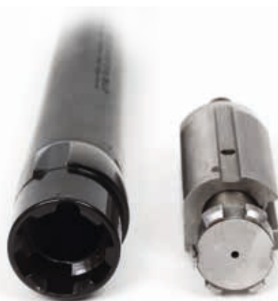
Abb. 4: Verriegelung durch einen sich drehenden Verschlusskopf, Kammer (l.) und Verschluss (r.)
