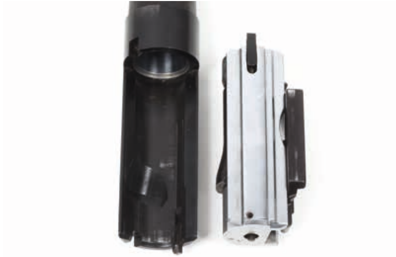
Abb. 5: Verriegelung durch eine Nase aus Metall, Kammer (l.) und Verschluss (r.)
