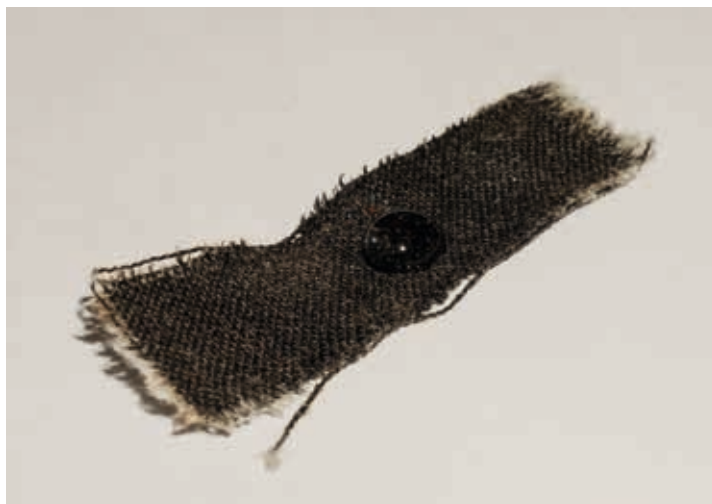
Abb. 11: Wassertropfen auf einem mit Birkenteer imprägnierten Baumwollgewebe (Foto: Angelika Wimmer).
