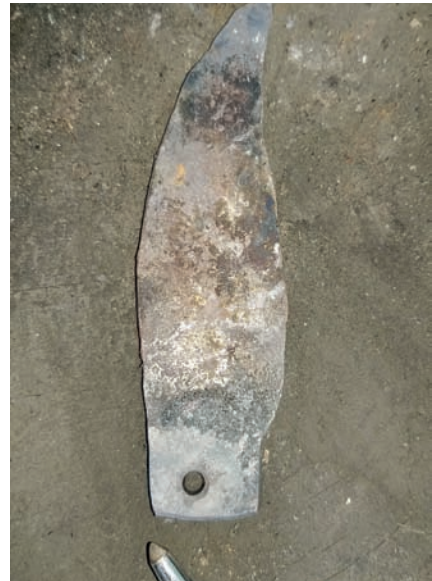
Abb. 9.4: Mit Körner und Durchschlag wird das Loch für die Drehachse auf den nötigen Durchmesser geweitet.
