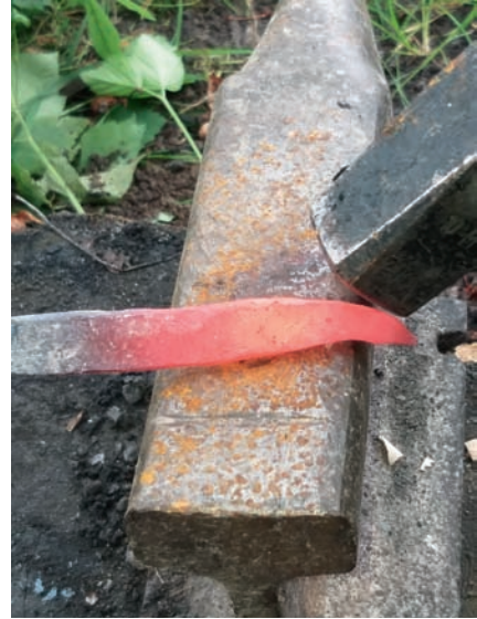
Abb. 9.2: Der Rohling erhält eine Spitze, wird grob geformt und anschließend dünn ausgeschmiedet.
