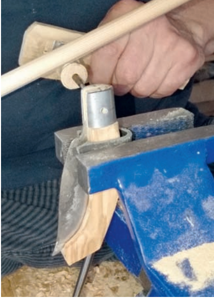
Abb. 9.13: Die aus Eisenblech geschnittene Zwinne wird passgenau gebogen und auf den ausgearbeiteten Griffzapfen aufgeschoben. Mithilfe eines Fiedelbohrers werden die Löcher für den Niet durch Zwinne und Holzgriff gebohrt.
