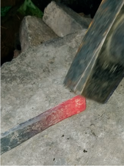
Abb. 9.1: Der Klingenrohling wird durch Schmieden eines Zaineisens aus Kohlenstoffstahl geformt (Fotos Abb. 9.1 bis 9.15: Thomas Lessig-Weller).
