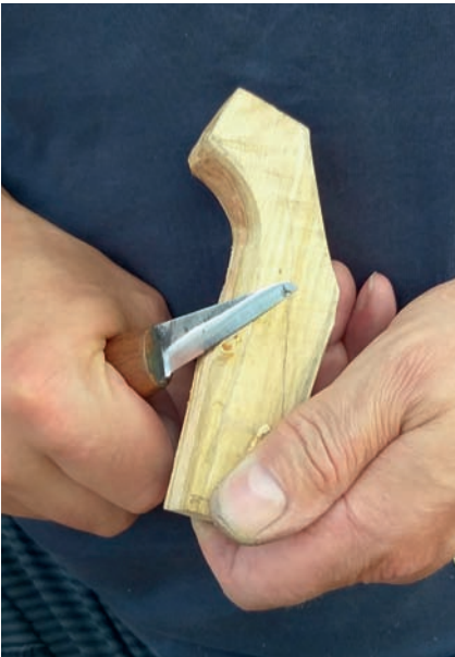
Abb. 9.11: Mit dem Messer erfolgt die grobe Formung des Griffs.
