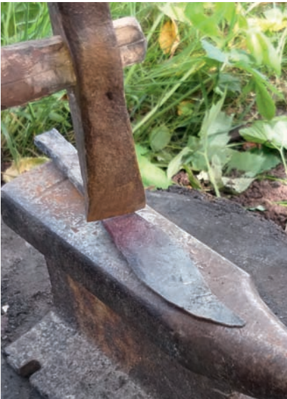
Abb. 9.3: In rotglühendem Zustand erfolgt das Abschroten des Klingenrohlings.
