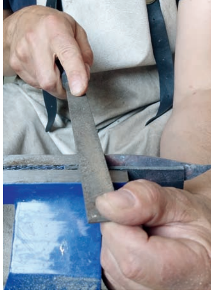
Abb. 9.6,7: Die Formung der zuvor weichgeglühten Klinge erfolgt mit Hilfe einer Feile.
