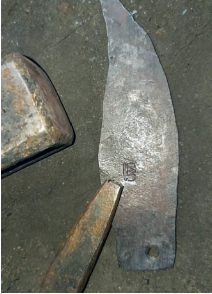
Abb. 9.5: Prägen der Klinge mit einem Schmiedestempel.
