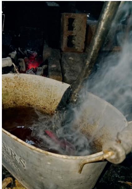
Abb. 9.8: In einem mit Öl gefüllten Behälter wird die zuvor normalisierte, rotglühende Klinge gehärtet.
