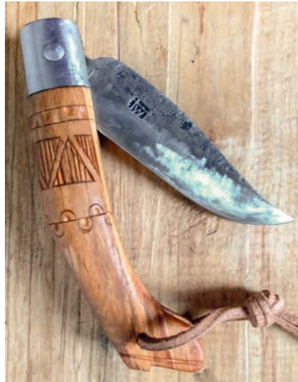
Abb. 9.15: Feilen und Ziehklinge dienen der Formung des Griffes. Nachdem die Verzierungen mit einem Schnitzmesser angebracht und die Oberfläche mit Schachtelhalm geglättet wurden, schützt ein Bad in Leinöl die Oberfläche.
