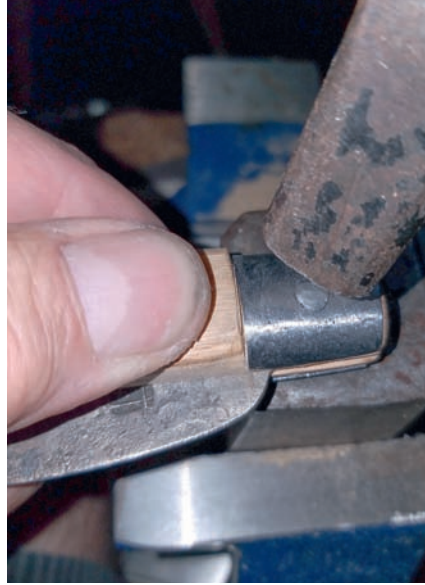
Abb. 9.14: Die Klinge wird eingesetzt, ein passender Metallstift durch die zuvor gebohrten Löcher gesteckt und vernietet.
