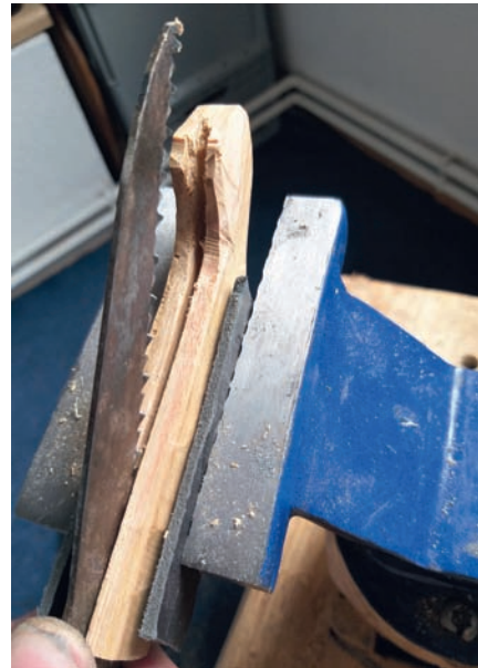
Abb. 9.12: Der Schlitz zur Aufnahme der Klinge wird in den Holzgriff gesägt.
