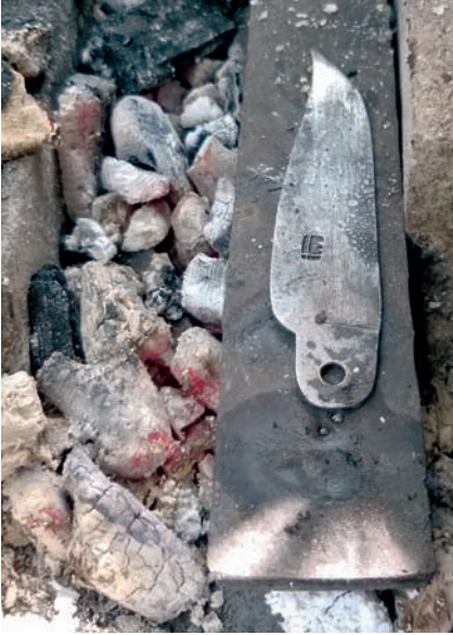
Abb. 9.9: Die Klinge wird auf einem in der Glut liegenden Kupferstück angelassen.
