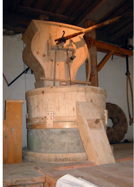
Abb. 25: Inneneinrichtung mit der Goss, den beiden Mahlsteinen Läufer und Läger und dem Mehlgang (Foto: Karl Zimmerhackl).
