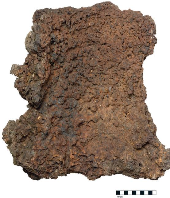
Abb. 3: Innen verschlacktes Schachtfragment aus Schlackenhügel 2.
