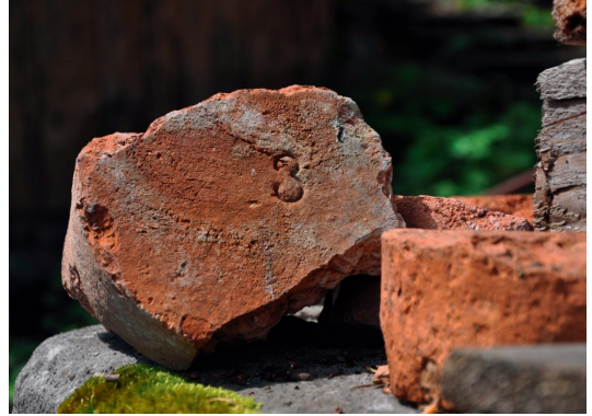
Abb. 7: Bruchstücke zylindrischer Pfannsteh mit Ziegelmarke, sekundäre Verwendung als Mauerziegel.
