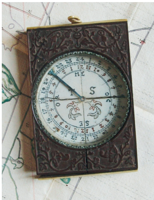
Abb. 7: Hängekompass mit den Initialen „T S“ des Bergmeisters Tobias Stüger. Transformations-Kompass zur Umstellung der Messtechnik durch den Bergmeister von einer rechts-läufigen 24 Stunden-Bezifferung (schwarze Ziffern) auf eine zweimal 12 Stunden-Bezifferung entgegen den Uhrzeigersinn (rote Ziffern).
