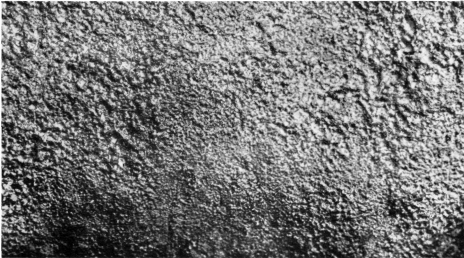
Abb. 11. Schmelzrinne auf einer Randfläche der Rückseite.
