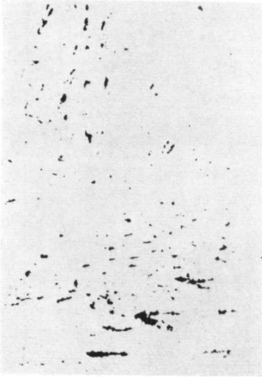
Bild 3: Römisches Eisenmesser, Einschlusskonzentration im Kern.
