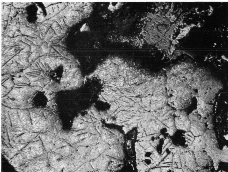
Bild 1: Römisches Eisen (Setzkeil), Gefüge im Anlieferungszustand.
