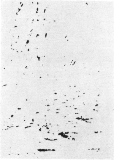
Bild 3: Römisches Eisenmesser, Einschlusskonzentration im Kern. Schliff ungeätzt. Vergrößerung: 80fach.
