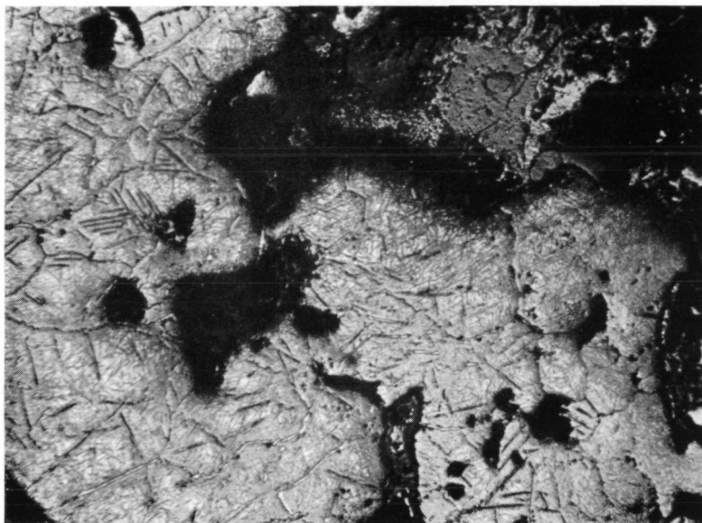
Bild 1: Römisches Eisen (Setzkeil), Gefüge im Anlieferungszustand. Ätzung: Alkoholische Salpetersäure. Vergrößerung: 70fach.
