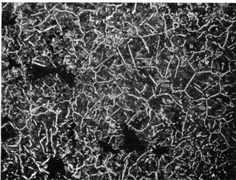
Bild 2: Römisches Eisen (Setzkeil), Gefüge nach Normalglühung und
