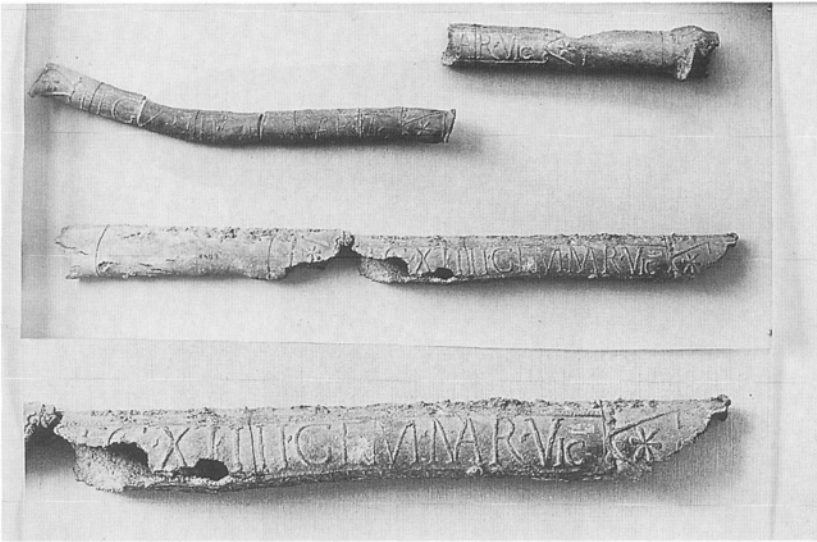
Abb. 13. Teile von römischen Bleirohrleitungen mit Stempel der LEG(io) XIV MAR(tia) Vic(trix). FO: Schützenhofthermen (Czysz 1994).
