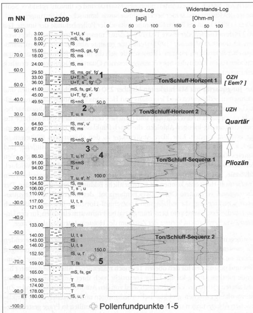
Abb. 2. Bohrprofil und Geophysiklogs der Bohrung 2209 Eich.
