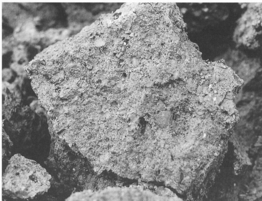
Abb. 3: Gesteinsproben mit Schiefer und Quarz als Gemeinteile. In der Bildmitte größerer Quarzpartikel von etwa 1 cm Durchmesser.
