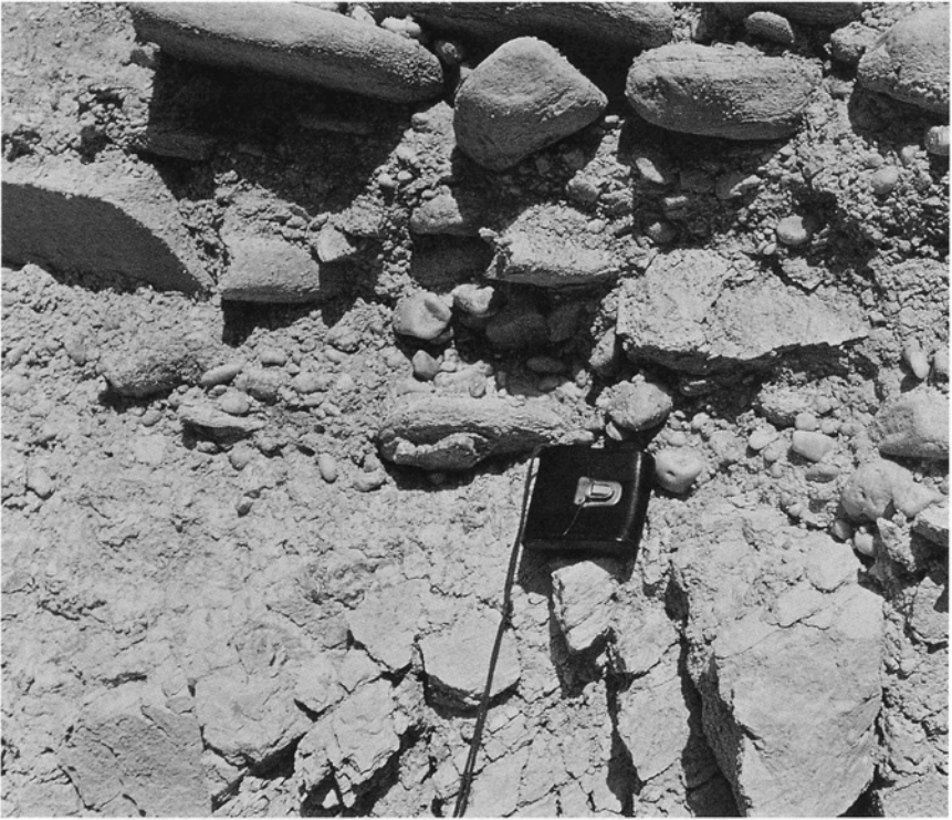
Abbildung 11: Detail des tertiären Basiskonglomerats, hier auf Serizitgneis, in der Baugrube Idsteiner / Ecke Schumannstraße (vergleiche Abbildung 10). Die gute Rundung der Blöcke spricht für eine intensive Aufarbeitung im fluvial beeinflussten Brandungsbereich der Tertiärküste am Südrand des Taunus. (Foto vom Juli 1970)
