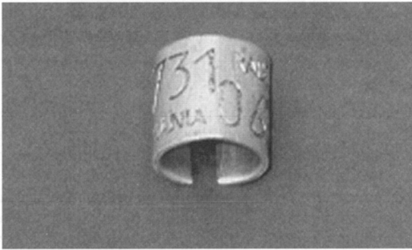
Abbildung 1: Aluminium-Ring nach längerer Tragezeit. Die Inschrift ist durch Schmutzeinlagerung deutlich sichtbarer geworden. Die Ziffern sind versetzt zweimal eingepägt
