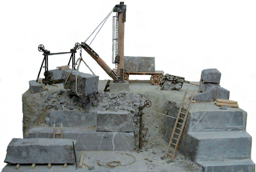
Abbildung 3: Steinbruchbetrieb mit Derrick-Kran, Holzpfählen und Drahtseilsäge (Modell von A. Becker, Verein „Lahn-Marmor-Museum“).
