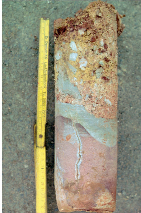
Abbildung 8: Bohrkern aus dem Untergrund bei der Hugo-Asbach-Straße. Unten klüftiger Quarzit, darüber kiesig-brekziöses tertiärzeitliches Sediment.
