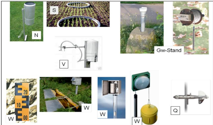
Abbildung 7: Hydrometeorologische und hydrologische Messgeräte bzw. Einrichtungen.
