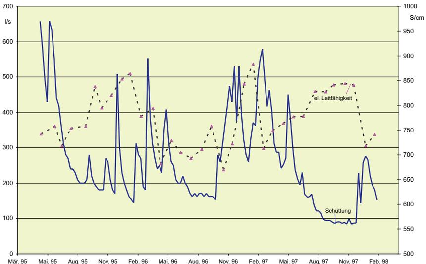
Abbildung 11: Schüttung und elektrische Leitfähigkeit des Wassers der Kressenteichquelle Breitau.
