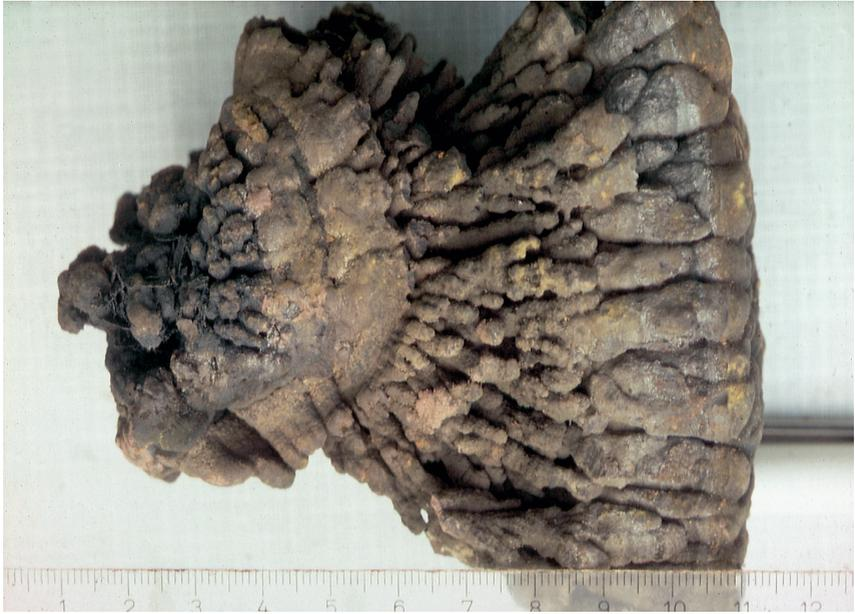
Abbildung 4: Wad, gelförmig-schaumig-poröses, erdig-mulmiges Manganerz. Waldalgesheim bei Bingen (Slg. HLUG).
