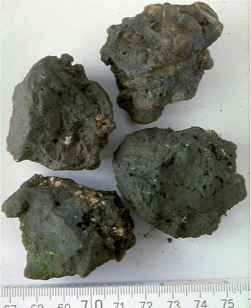
Abbildung 1: Knollenartiger Braunstein aus Abraumresten der Eisenmangangrube Hörkopf bei Assmannshausen (Abb. 5 Nr. 3).
