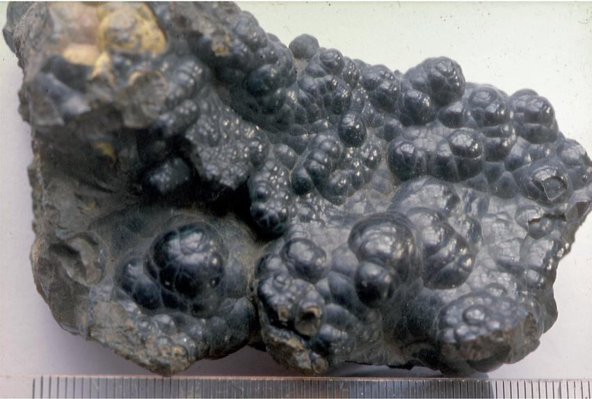
Abbildung 2: Psilomelan, „Schwarzer Glaskopf“, gelartig abgeschiedenes, radialstrahlig-fein-faseriges Manganerz. Grubenfeld Wilhelm bei Schlangenbad (Abb. 5 Nr. 14).
