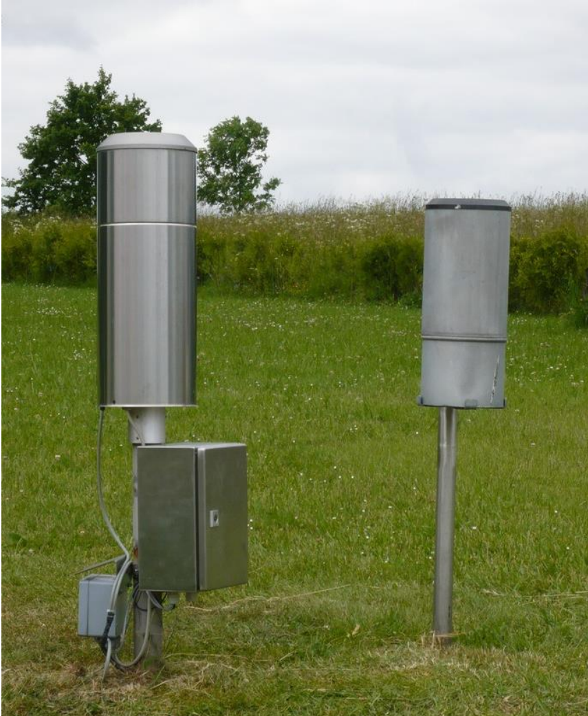
Abbildung 3: Links: Niederschlagsmesser mit automatischer Aufzeichnung und Datenfernübertragung (DFÜ) („Pluvio“), rechts: Niederschlagsmessgerät nach Hellmann; Foto: HLOG.
