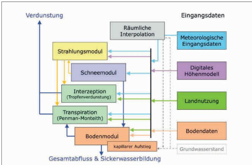
Abbildung 2: Modularer Aufbau des Bodenwasserhaushaltsmodells GWN-BW und schematische Darstellung der benötigten Eingangsdaten (KOPP et al. 2018).
