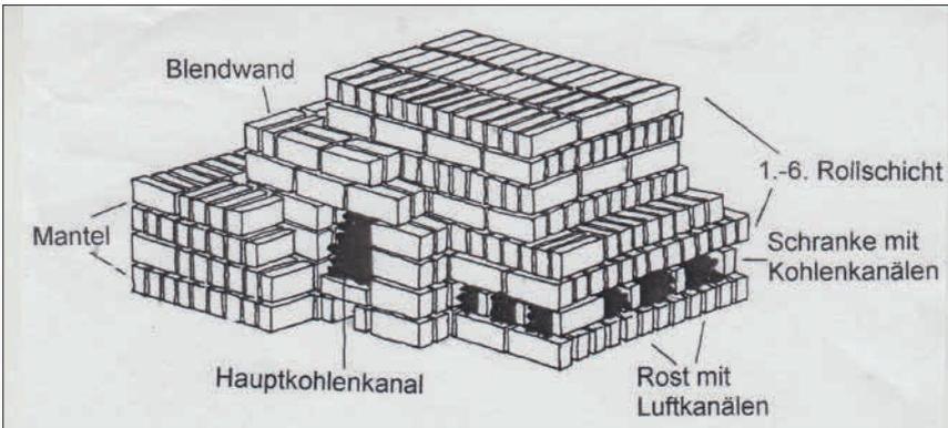
Abbildung 8: Aufbauschema eines Backsteinmeilers (nach WINTER 1937).
