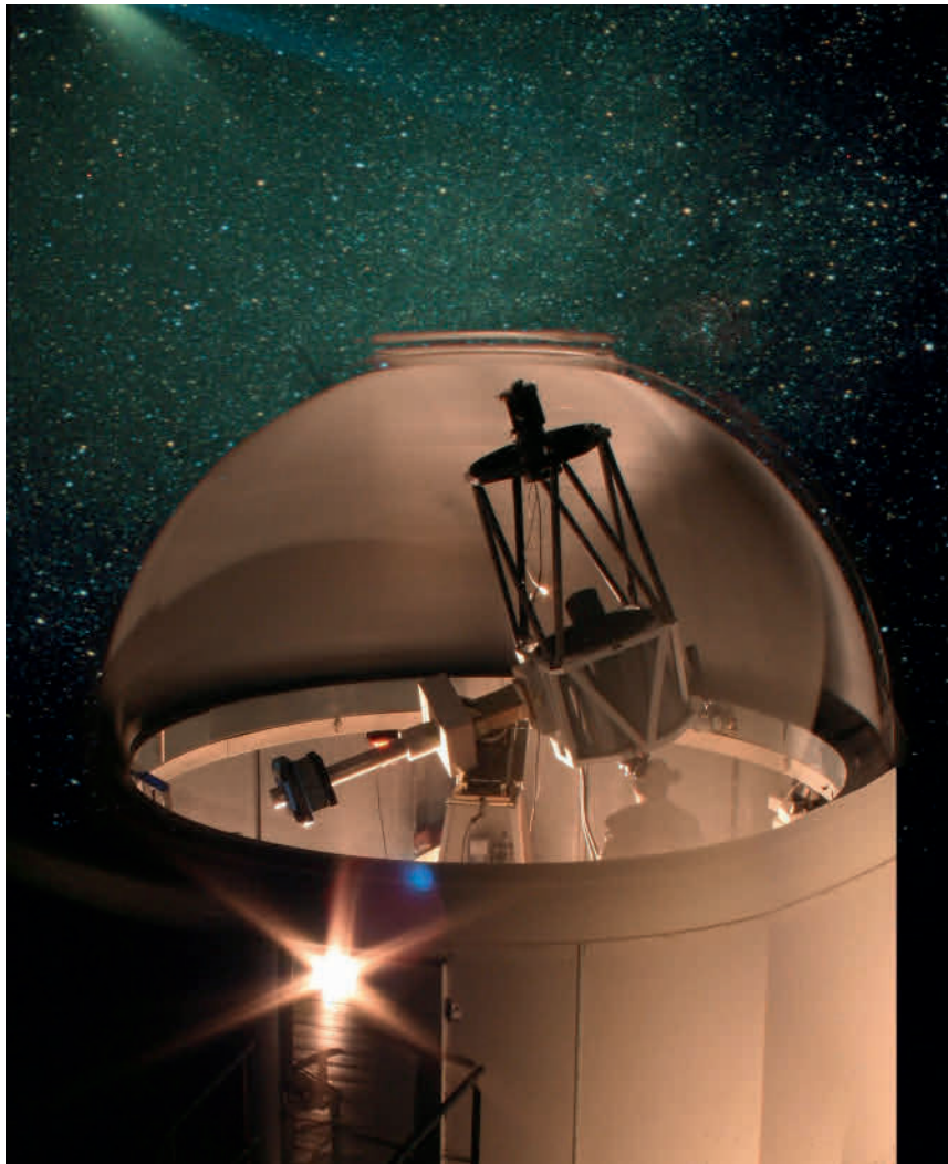
Abbildung 6: Kuppel und Teleskop des Taunus-Observatoriums. Am Cassegrain-Teleskop mit einem Spiegeldurchmesser von 60 Zentimeter wurden über 100 Kleinplaneten entdeckt; Foto: Erwin Schwab.
