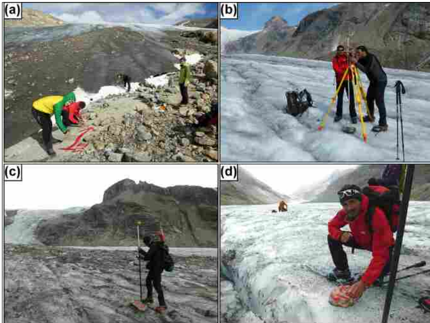
Abbildung 3: Fotografische Impressionen vom jährlichen Monitoring der Gletschergeometrie an der Pasterze und in ihrer Umgebung (Glocknergruppe, Hohe Tauern); (a) Maßbandmessung von fixen Punkten im Gletschervorfeld; (b) Traditionelle analoge Einmessung von Höhenpunkten mittels Tachymeter, mittlerweile ersetzt durch (c) differentielle GPS-Technologie (bzw. GNSS/Global Navigation Satellite Systems); (d) mit Zahlencode markierte Steine als Grundlage der Messung der Oberflächenbewegung; Fotos: Autoren.
