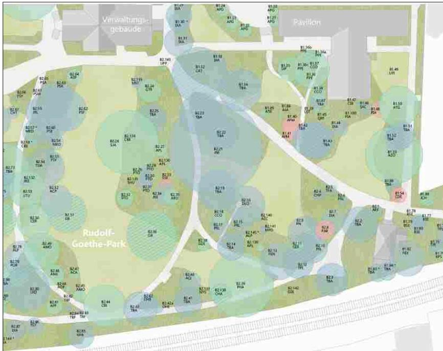
Abbildung 7: Ausschnitt aus dem Analyseplan des Rudolf-Goethe-Parks, in dem die Eignung der Bestandsbaumarten im Klimawandel dargestellt ist. Die Bestandsbäume sind mit Kurzbezeichnungen der Baumarten und Baumnummern versehen. Die farbige Markierung verweist auf die Eignung: grün = eher im Vorteil, blau = indifferent, rot = eher im Nachteil. Die Schraffur markiert Nadelbäume (FABER 2020, nicht maßstabsgetreu).
