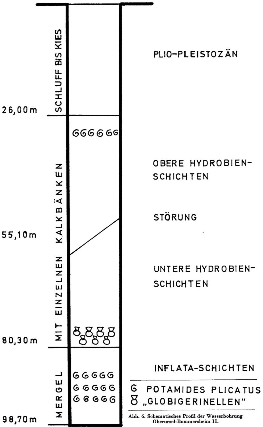
Abb. 6. Schematisches Profil der Wasserbohrung Oberursel-Bommersheim II.
