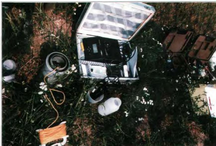
Stickstoffanalytik zur Grundwasserbeweissicherung im Klärschlammversuchsfeld Oberschützen.
