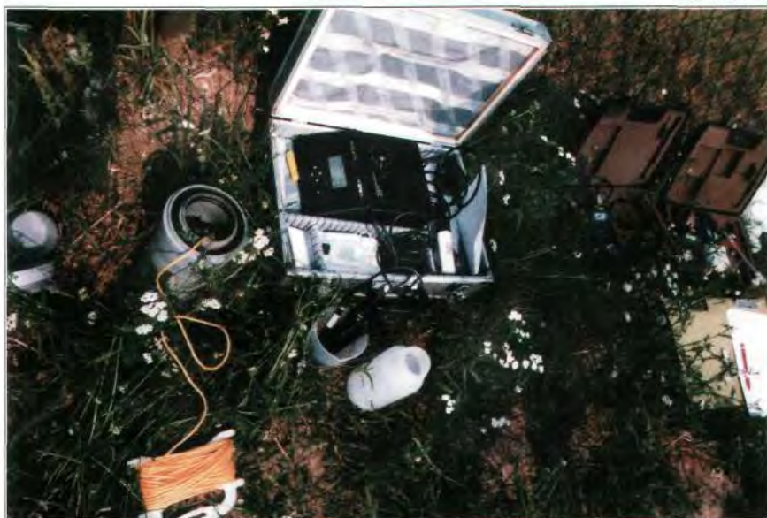
Stickstoffanalytik zur Grundwasserbeweissicherung im Klärschlammversuchsfeld Oberschützen.
