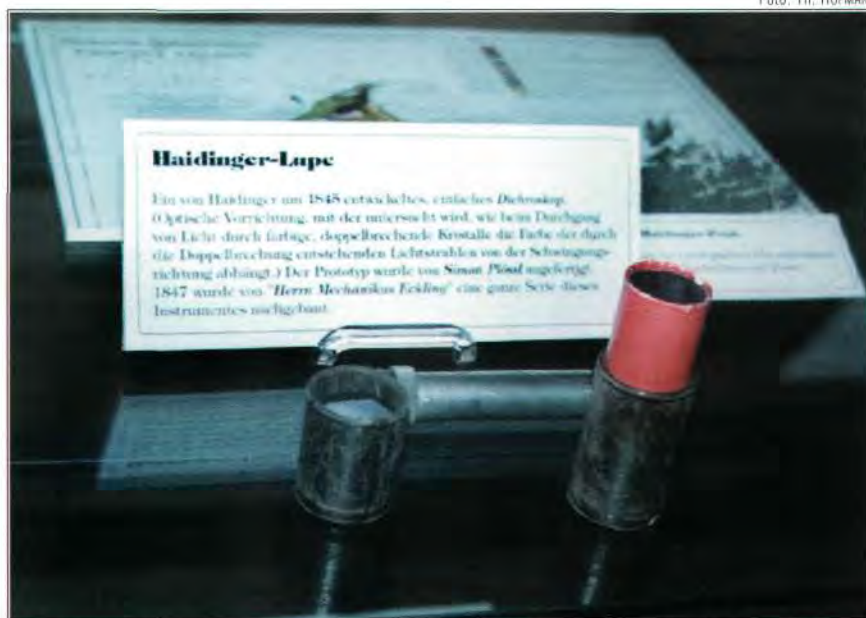
Die Haidinger-Lupe, ein kristalloptisches Präzisionsinstrument aus der Mitte des 19. Jahrhunderts.
